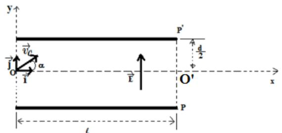
Données:  $v_0 = 8 \cdot 10^6 \text{ m} \cdot \text{s}^{-1}$ ,  $\alpha = 30^\circ$ ,  $d = 7 \text{ cm}$  ;  $l = 20 \text{ cm}$ ,  $e = 1,6 \cdot 10^{-19} \text{ C}$  et  $m = 9,1 \cdot 10^{-31} \text{ kg}$ .
