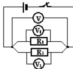
Dans un groupement en parallèle, la tension est la même aux bornes des différentes dérivations
