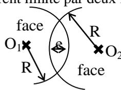
$R_1$  et  $R_2$  sont les rayons de courbures respectifs des faces 1 et 2
