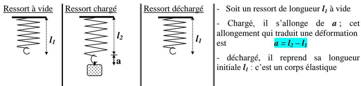
La déformation de ce corps élastique est due à une force : le poids de la charge
