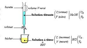
Un bêcher ou un erlemeyer pour contenir la solution à titrer *Une pipette jaugée* pour mesurer l'échantillon à doser. <u>Un agitateur</u> (souvent magnétique) pour uniformiser la solution.
